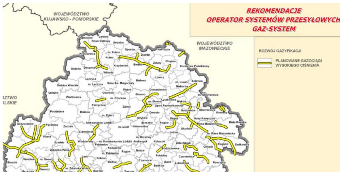
Rysunek 22. Sieć gazociągu wysokiego ciśnienia
